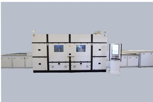
Mittels ultrakurzer Laserpulse wird der Werkstoff nicht verdampft, sondern durch Material-Dissoziation getrennt. Das Ergebnis ist eine sehr geringe Oberflächenrauigkeit, eine höhere Biegefestigkeit, sowie höherer Durchsatz.
