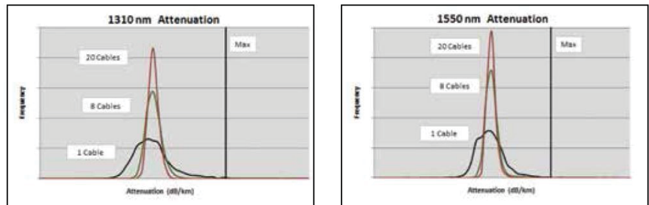
图 2A (左)，图 2B (右)：多光纤链路的串联光纤衰减分布
