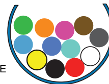
Querschnitt der Aderhülle
