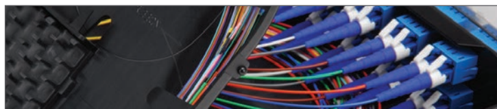
Cassettes d'épissure CCH avec pigtails colorés (protection thermorétractable)
