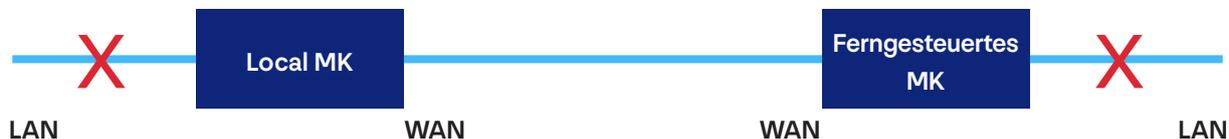
2. Der Link-Down-Status der WAN-Seite wird zunächst auf die LAN-Seite des lokalen Medienconverters und dann auf die LAN-Seite des entfernten Medienconverters übertragen.
