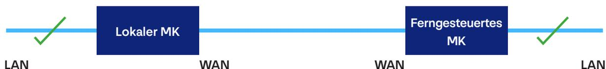
3. Wenn z. B. der LAN-Port des lokalen Medienconverters von "Link Down" wieder auf "Link Up" wechselt, hebt das System den LFP-Zwangsstatus des LAN-Ports des entfernten Medienconverters auf.
