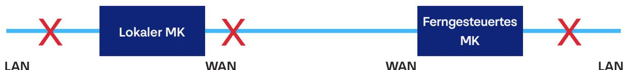
3. Wenn der LAN-Anschluss wieder eine Verbindung herstellt, hebt das System den LFP-Zwangsstatus des LAN-Anschlusses des Medienconverters auf.
